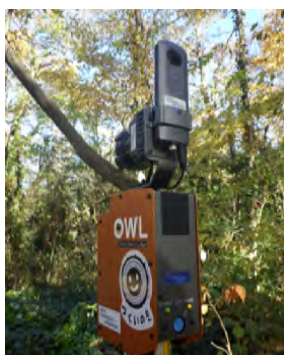
図5 地上レーザ計測機器「OWL」
