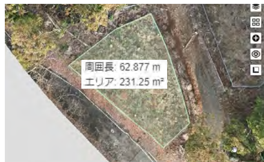
図3 オルソ画像で水平面積計測
