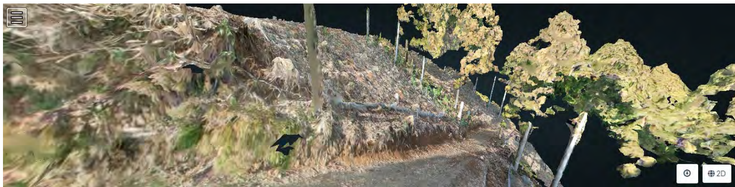
図1 表題画像の三次元点群に写真を張り付けて生成した3Dモデル。スギ林と植栽地の下側に道が入っています。
