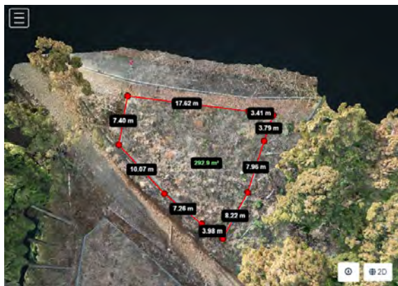
図2 植栽地が正面になるよう回転して、シカ柵延長と、植栽地の斜面積を測っています。
