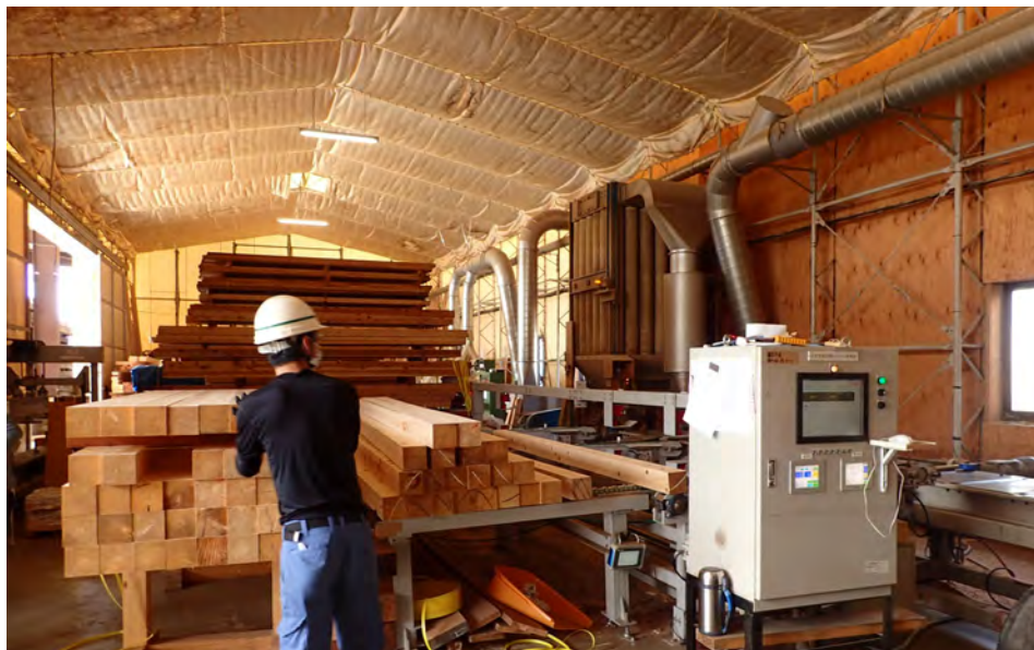
正角材に製材
