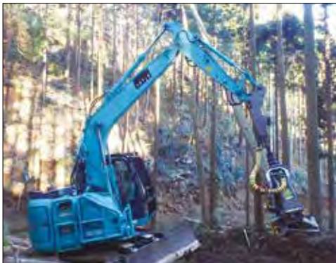
ハーベスタにより立木伐倒し、掴んだまま枝払い、測尺、玉切り
