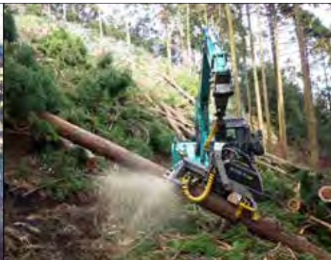
ハーベスタにより立木伐倒し、掴んだまま枝払い、測尺、玉切り
